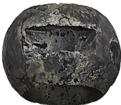
某进口品牌使用后球体严重腐蚀
