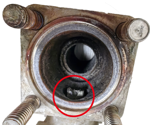
某进口品牌使用后阀杆及内部严重腐蚀
